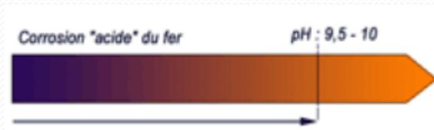
On parlera par exemple de corrosion acide du fer pour des pH inférieurs à 9,5...
