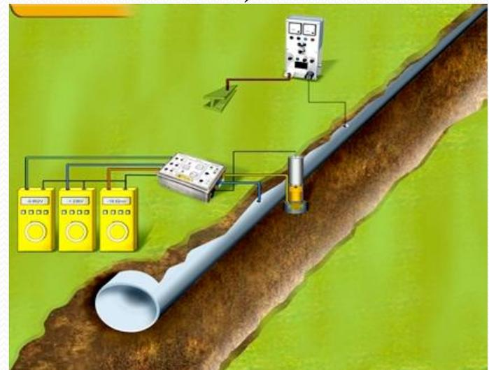
La *protection anodique* vise la mise en place d'une couche de passivation résistante à la corrosion.
