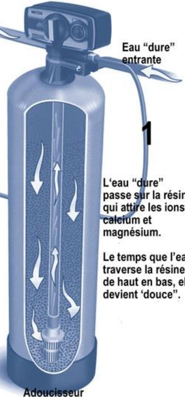
L'eau "dure" passe sur la résine qui attire les ions calcium et magnésium.
