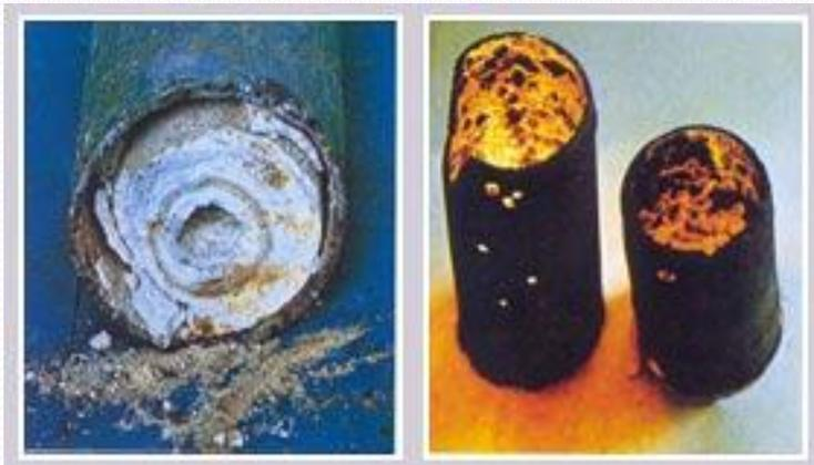
Entartrage ou Corrosion
