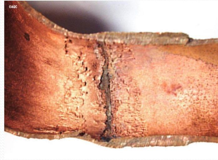
P. Ex. Un écoulement trop rapide provoque l'usure d'un coude
