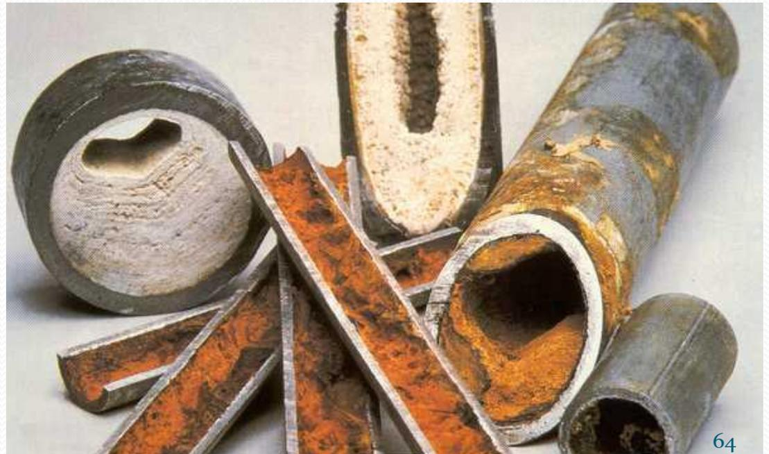
L'eau dure est donc à la fois un désagrément et un fardeau économique pour le consommateur. On prétend qu'une dureté comprise entre 80 et 100 mg/L de  $\text{CaCO}_3$  assure un équilibre acceptable entre la corrosion et l'entartrage.
