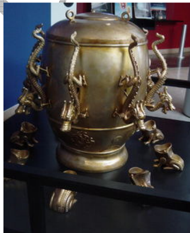
Figure 3.3 : Réplique du sismographe de Zhang Heng
