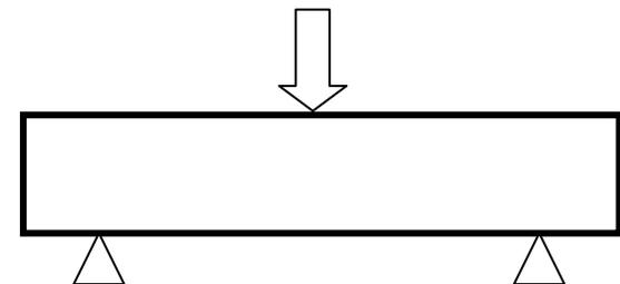
Déformation linéaire : Toute contrainte sur un objet est suivie d'une déformation. La déformation qui résulte dans la direction de la force appliquée est appelée déformation linéaire  $[\varepsilon] = \% .$
