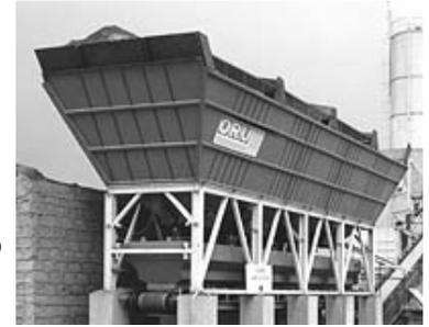
i. centrale verticale où les manutentions s'effectuent par gravité à partir de trémies ou de silos situés au dessus des bascules et du malaxeur,
