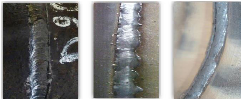
Figure 107 : Exemple Manque de pénétration
