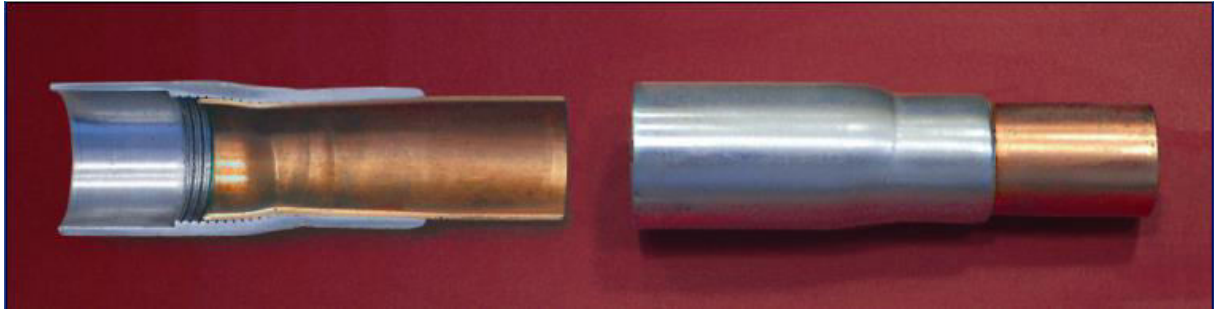
Figure 79 : Soudage par TIM d'un tube en alliage d'aluminium sur un tube en cuivre
