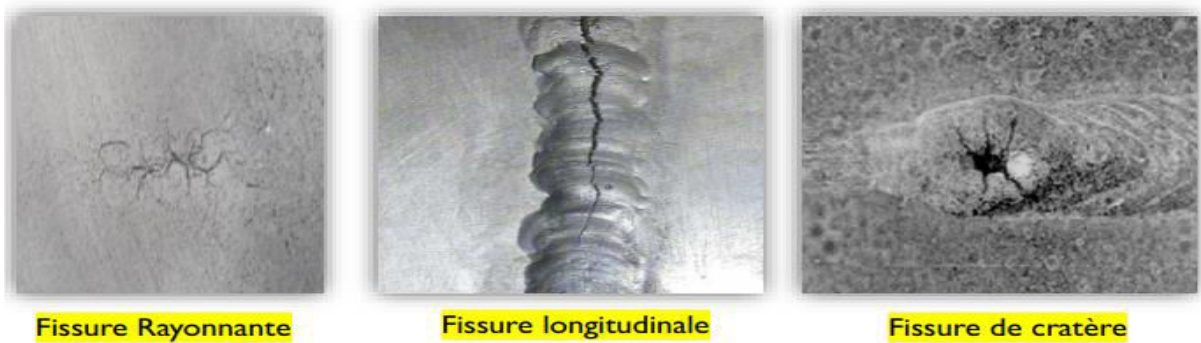
Figure 99 : Exemples des défauts de fissure -3-
