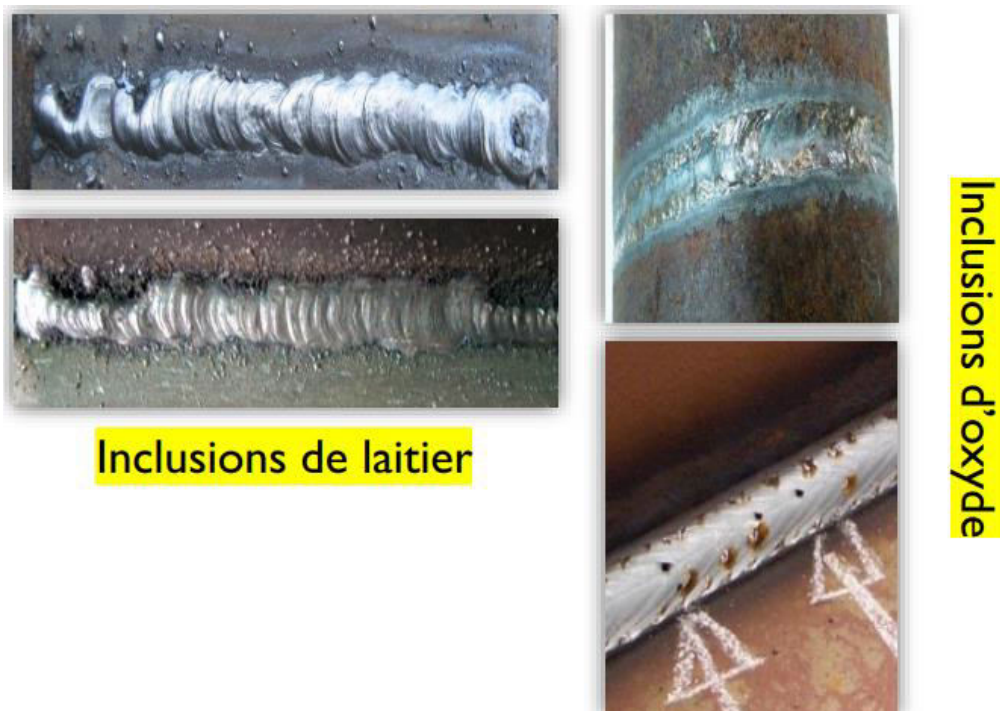
Figure 105 : Défauts inclusions solides
