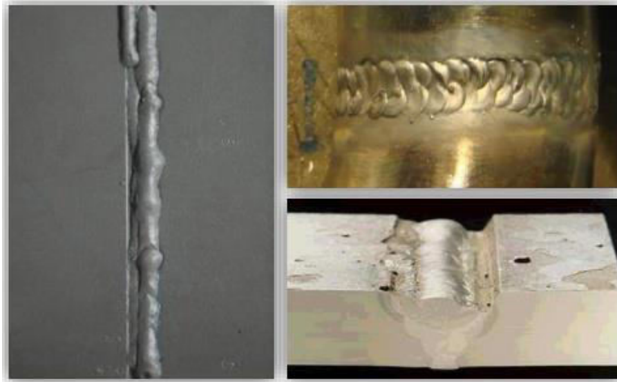
Figure 112 : Défaut de Manque d'Épaisseur-concavité
