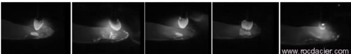
Figure 11 : Transfert par court-circuit
