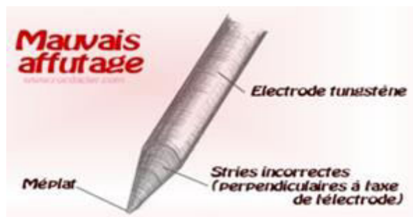
Figure 50 : Mauvais affûtage d'une électrode
