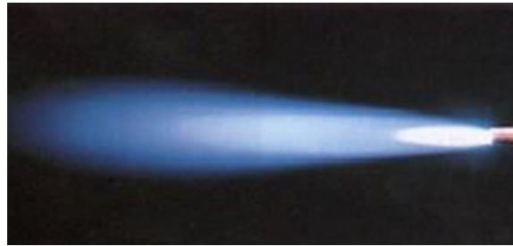
Figure 63 : Flamme chalumeau comburante – Mauvais réglage – Excès d’acétylène/propane/...
