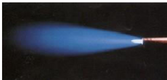
Figure 61 : Flamme chalumeau normale – Réglage parfait
