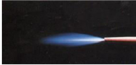
Figure 62 : Flamme chalumeau oxydante – Mauvais réglage – Excès d’oxygène
