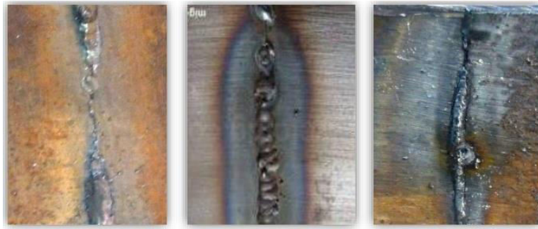
Figure 106 : Manque de pénétration
