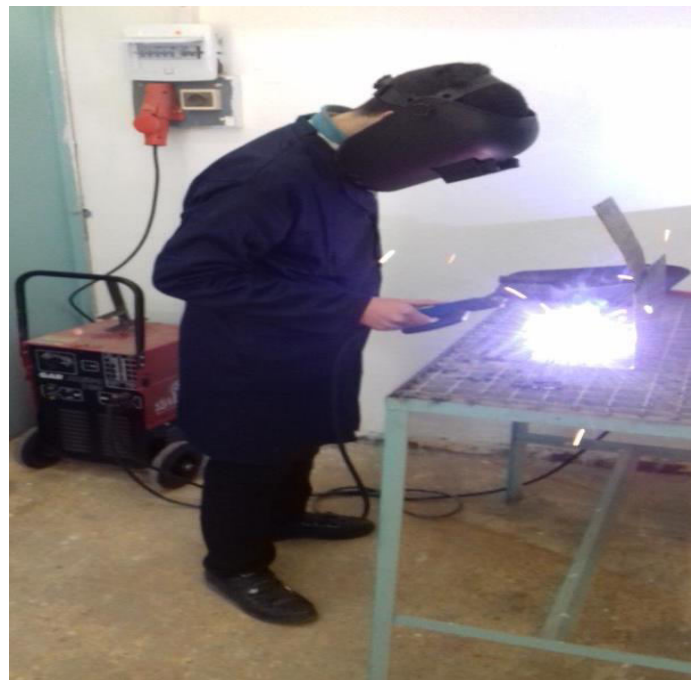
Figure 3 : Soudage à l'arc à l'électrode enrobée
