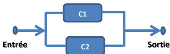
Etape 02 : on calcule la fiabilité des composants  $r_i$  sachant que  $R_{sys} = 0.9$
