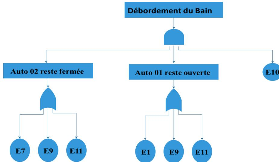
Avec **E1** : auto 01 bloquée ouverte, **E7** : auto 02 bloquée fermée, **E9** : Interrupteur défaillant, **E10** : Flotteur défaillant et **E11** : Batterie défaillante
